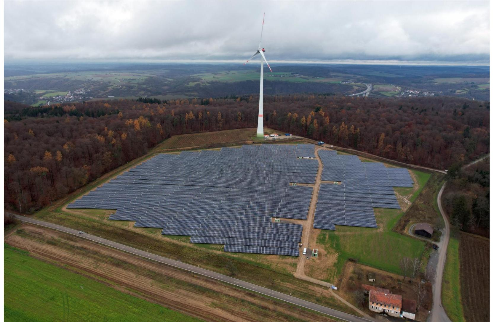
Hybridpark der BürgerEnergie Widdern: Freiflächen-Photovoltaik & Windenergie versorgen unter anderem die Wasserstoffherzeugung am DLR. Das verfallene Gebäude unten rechts wird mit Erlösen der FF-PV saniert und als Infozentrum und Versammlungsstätte ausgebaut.
